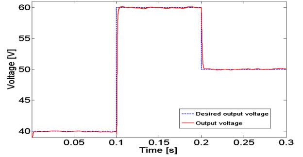
Fig. 4. Reference and actual output voltage step changes
